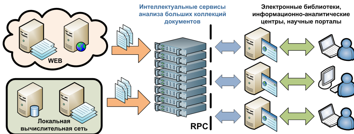
Рис. 1 – Архитектура программно-аппаратного комплекса интеллектуального поиска и анализа больших массивов текстов
